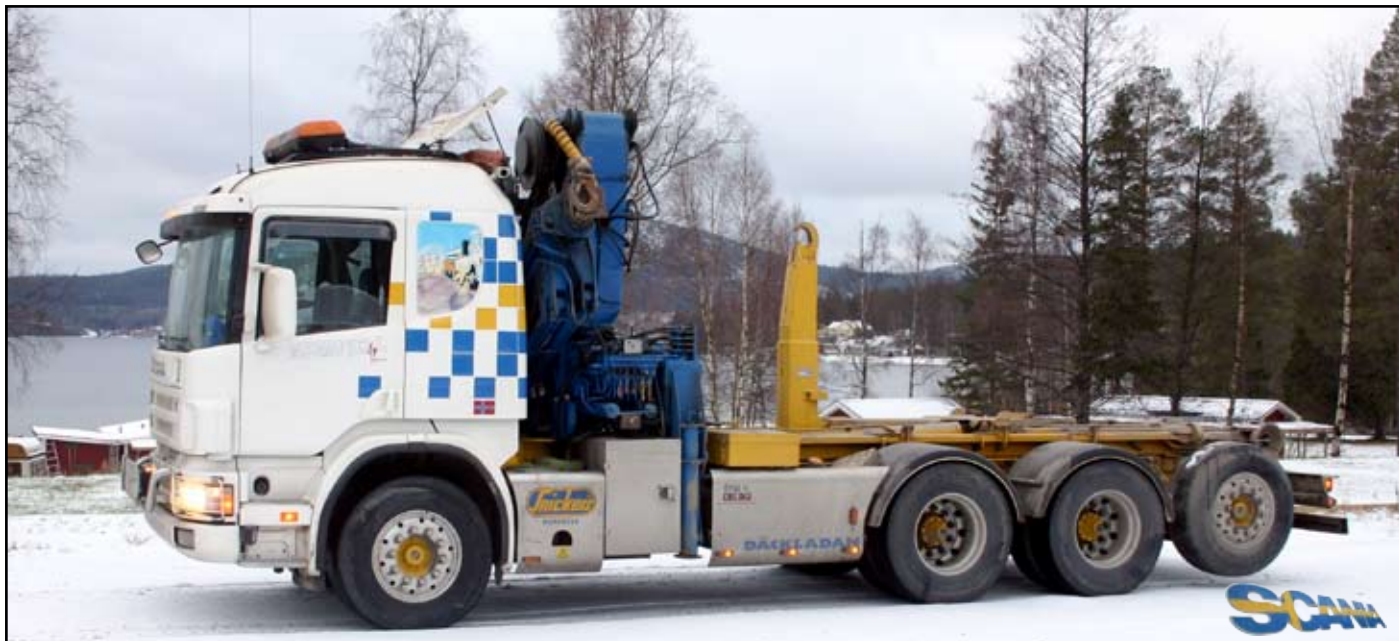
Scania P 124 8x4*4 12 liters motor på 420 hkr (Styrning på första och sista axeln.) Utrustad med lastväxlare och kran, Hiab 30 ton/meter
